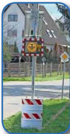
Dem Autofahrer wird die tatsächlich gefahrene Geschwindigkeit angezeigt und über ein lachendes und weinendes Gesicht Rückmeldung gegeben, ob die zulässige Höchstgeschwindigkeit eingehalten wurde. Durch die unmittelbare Verhaltensrückmeldung kann eine Reduzierung der gefahrenen Geschwindigkeiten erreicht werden, zusätzlich wird von der Anlage die Anzahl der gemessenen Fahrzeuge erfasst.
